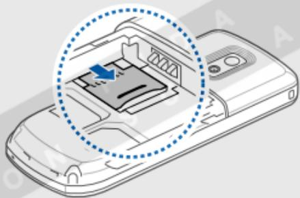
3. Levante el soporte de la tarjeta de memoria e inserte una tarjeta de memoria con la etiqueta orientada hacia arriba.
